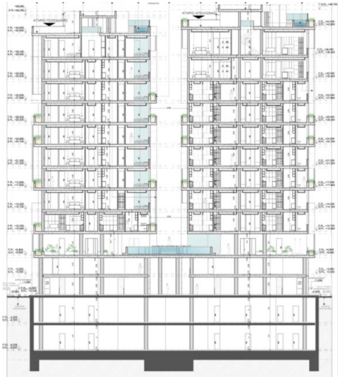
Σχήμα 5.1-1: Κοινή αρχιτεκτονική τομή των προτεινόμενων κτιρίων «Απόλλωνα» και «Ποσειδώνα»
