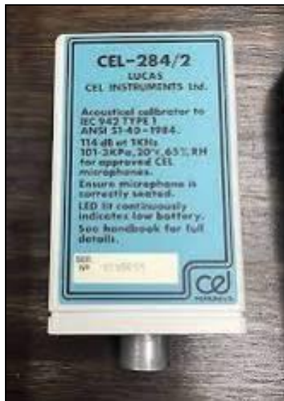
Εικόνα 7-3: Όργανο βαθμονόμησης CEL-284/2 Acoustical Calibrator Class 1L
