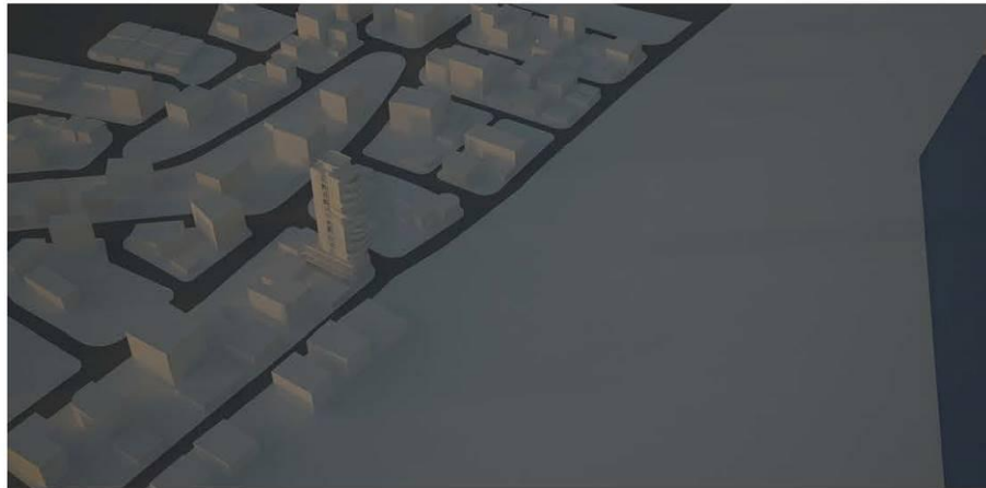
Σχήμα 13: Προσομοίωση σε υπολογιστικό πρόγραμμα του υπό ανέγερση κτιρίου και των γειτονικών Υφιστάμενων.- Μελέτη Σκίασης κατά τον Μήνα Δεκέμβριος – Ώρα 16:00
