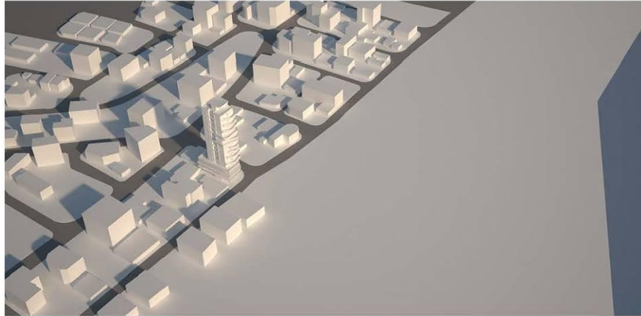
Σχήμα 2: Προσομοίωση σε υπολογιστικό πρόγραμμα του υπό ανέγερση κτιρίου και των γειτονικών Υφιστάμενων.- Μελέτη Σκίασης κατά τον Μήνα Μάρτιο – Ωρα 08:00
