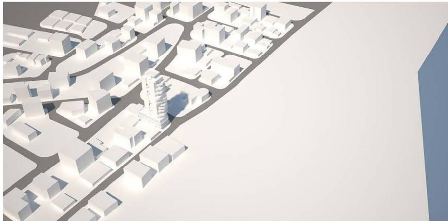
Σχήμα 3: Προσομοίωση σε υπολογιστικό πρόγραμμα του υπό ανέγερση κτιρίου και των γειτονικών Υφιστάμενων.- Μελέτη Σκίασης κατά τον Μήνα Μάρτιο – Ωρα 12:00
