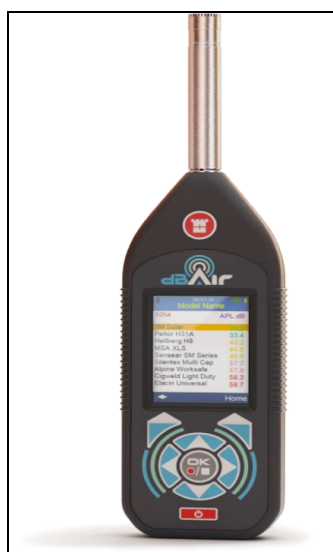
Εικόνα 7-2: Μετρητής θορύβου Castle dB Air Model GA 141
