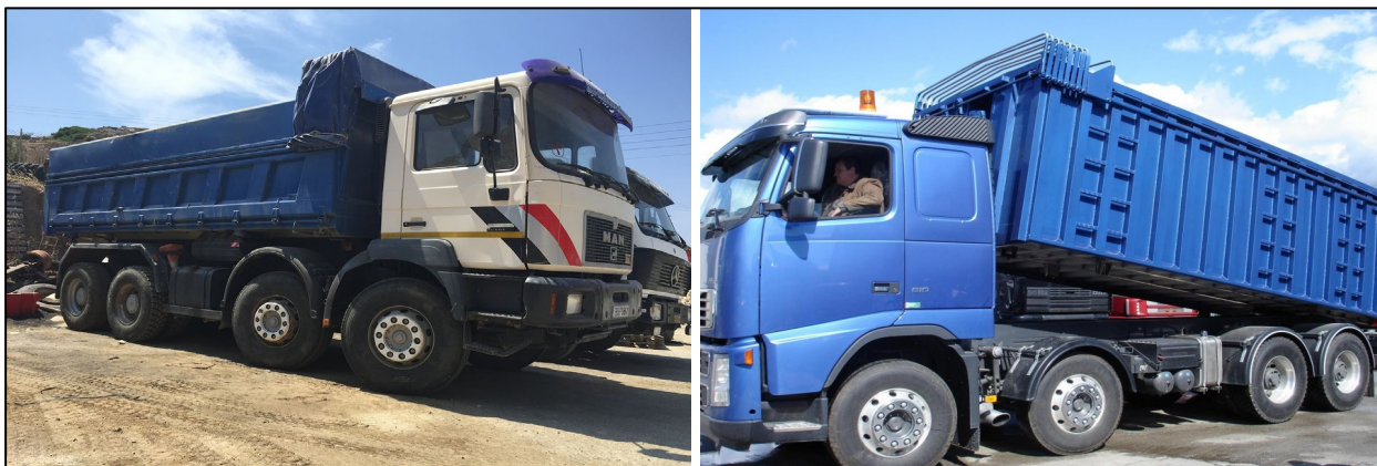
Εικόνα 6-3: Φορητά μεταφοράς αδρανών
