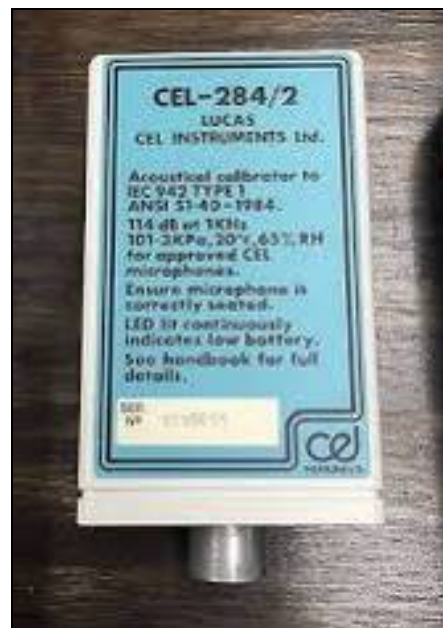
Εικόνα 7-3: Όργανο βαθμονόμησης CEL-284/2 Acoustical Calibrator
