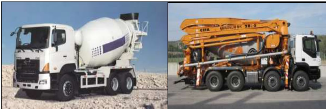
Εικόνα 6-7: Μπετονιέρα/ Αντλία σκυροδέματος
