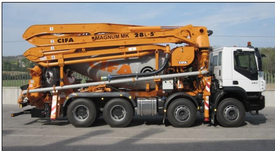
Εικόνα 6-10: Αντλία σκυροδέματος (κάτω)
