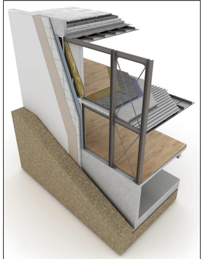
Εικόνα 6-4: Τυπική τομή σύμμικτης κατασκευής
